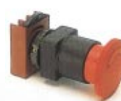
Przycisk grzybkowy awaryjny (zwolnienie przez obrót) wg EN418 ∅ 40 mm
