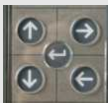
Fig 2.2 Key pad Abb. 2.2 Tasten Fot. 2.2 Up Oben W gór Down Unten W dół Right (Next) Rechts (Nächster) W prawo (Następny) Left (Previous) Links (Voriger) W lewo (Poprzedni) Enter (Save) Sichern Enter (Zapis)
