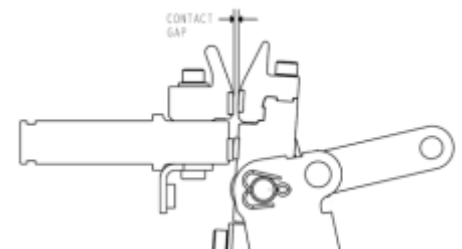
Fig 5.2: contact gap / Abb. 5.2 Kontaktabstand Fot. 5.2: Szczelina między stykami
