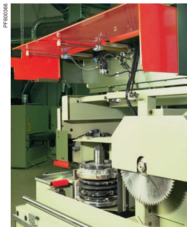
Przykład aplikacji (piła do cięcia) wymagająca obligatoryjnie zastosowanie funkcji bezpieczeństwa.
