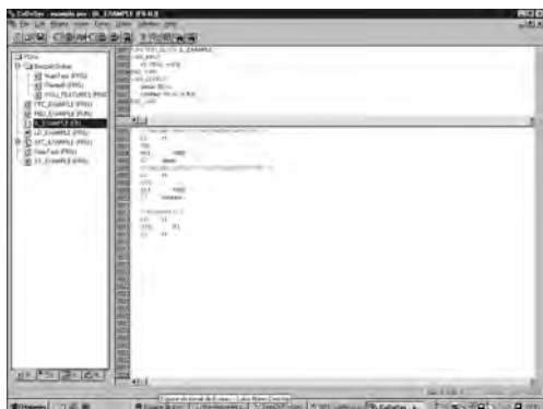
Przykład programowania za pomocą listy instrukcji
