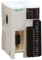
Moduł interfejsu CANopen OTB 1C0 DM9LP
