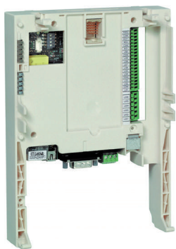
Sterownik PLC zintegrowany z przemiennikiem częstotliwości Altivar 61/71
