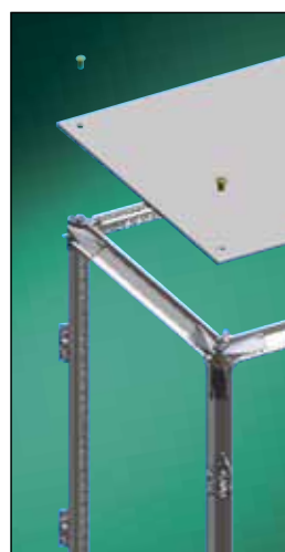
Element narożnikowy umożliwia prosty montaż płyt górnych szafy. W element ten wkręcane są śruby mocujące płytę górną bądź śruby z uchem umożliwiające podnoszenie szafy za pomocą dźwigu.
