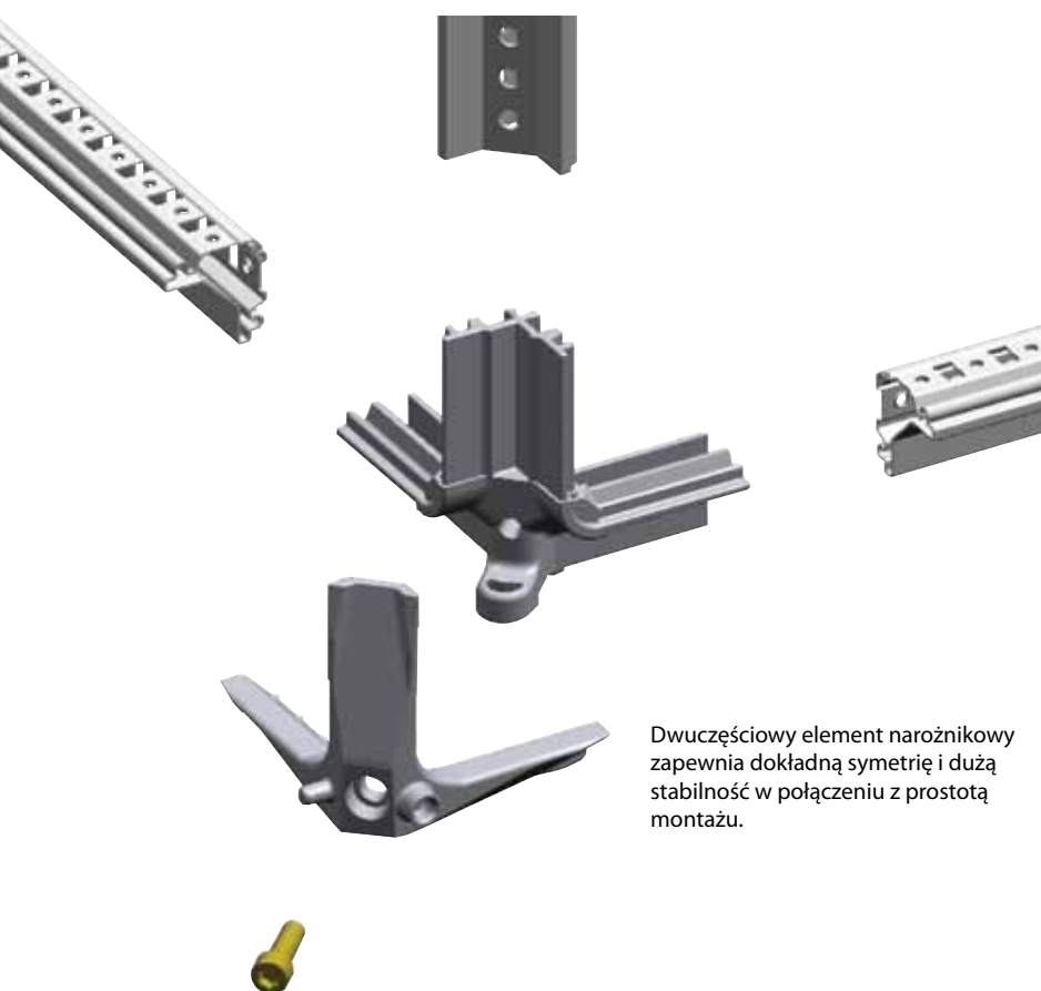
Element narożnikowy umożliwia prosty montaż płyt górnych szafy. W element ten wkręcane są śruby mocujące płytę górną bądź śruby z uchem umożliwiające podnoszenie szafy za pomocą dźwigu.
