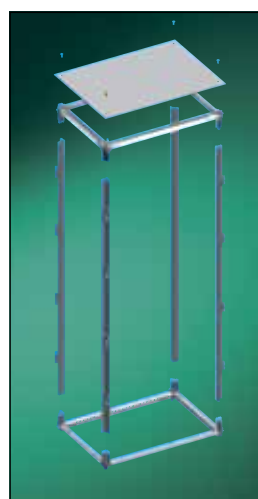
Element narożnikowy umożliwia prosty montaż płyt górnych szafy. W element ten wkręcane są śruby mocujące płytę górną bądź śruby z uchem umożliwiające podnoszenie szafy za pomocą dźwigu.
