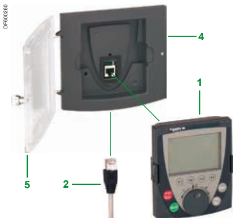
Użycie graficznego terminala zdalnego na drzwiach obudowy 1 + 2 + 4 (+ 5, jeśli IP65)
