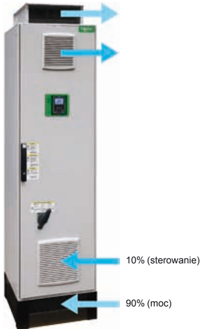
System chłodzenia z dwoma oddzielnymi kanałami powietrza
