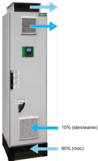
System chłodzenia z dwoma oddzielnymi kanałami powietrza
