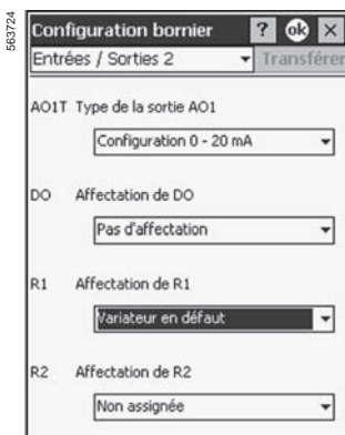
Konfigurowanie przekaźnika błędu z PowerSuite na palmtopie
